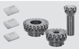
し、ボディから調整用の部品を排除した事である。こうする事で、調整機構やその操作に必要なスペースをミニマム化し、φ100で22枚刃を達成した。レンチを持ち替えず調整できるように工夫されており、操作時間を約45%短縮した。
