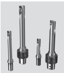
従来の刃先交換式ドリルでは、穴入り口径方向(Y軸)に大きな切削抵抗がかかり、穴の拡大代が大きくなりびびり発生の原因となるが、同製品はダブルステップテクノロジーを採用することで食いつきがスムーズになり、業界初の7Dの加工をパイロット穴無しで行うことが可能となった。
