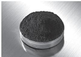
今般、原料、還元工程、炭化工程の最適化を図ることにより、W粉やWC粉の凝集を抑制したことに新規性がある。
